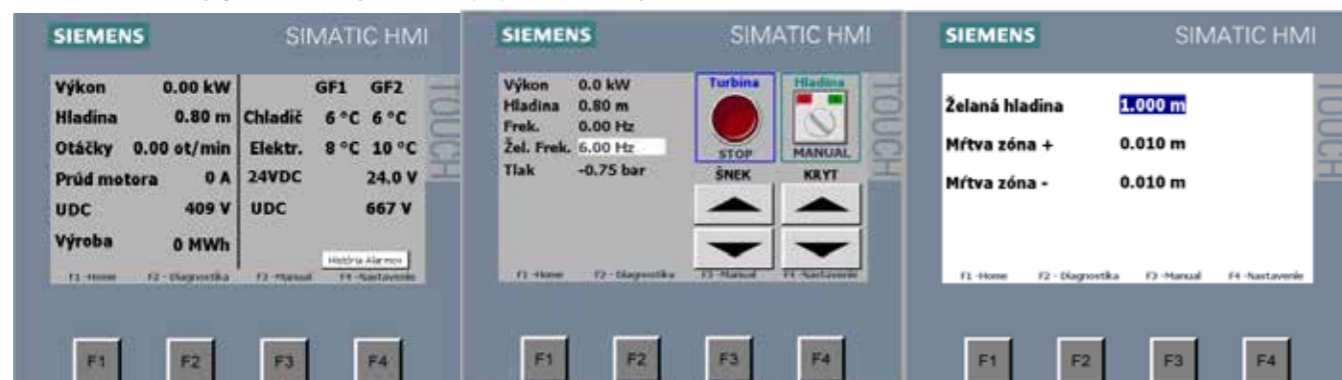
▼ Príklad obrazovky grafického dotykového displeja riadiaceho systému MVE.
